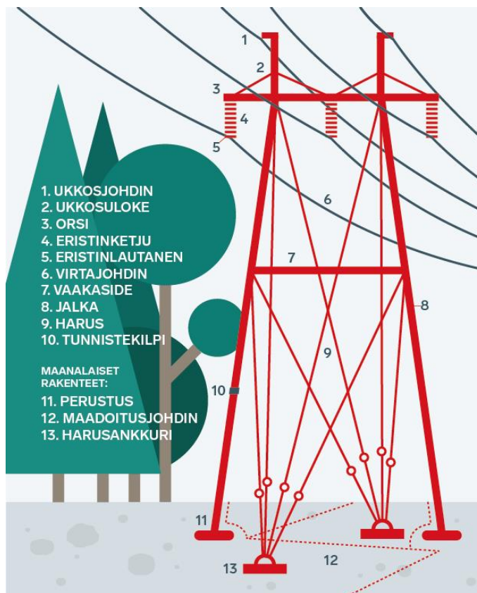
Kuva 6-4. Voimajohdon osat (Fingrid, 2022).
