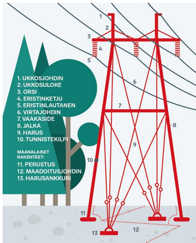
Kuva 6-4. Voimajohdon osat (Fingrid, 2022).
