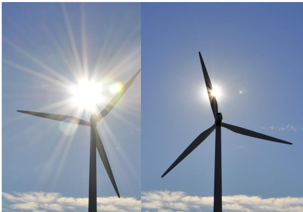
Kuva 60. Tuulivoimaloiden lavat aiheuttavat pyöriessään vilkkumista ja varjon välkkymistä aurinkoisella säällä.
