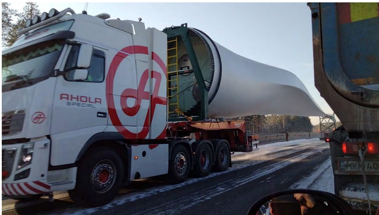
Kuva 6-72 Tuulivoimalan lavan kuljetusta.
