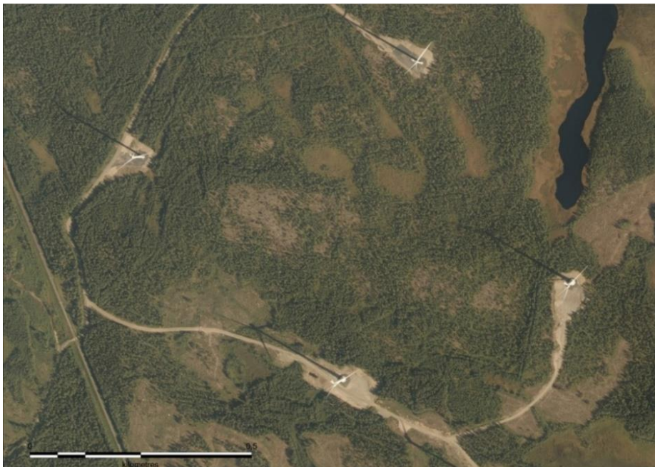
Kuva 89. Ilmakuvasa näkyy toiminnassa olevia tuulivoimaloita. Tuulivoimaloita varten on rakennettu huoltotiet ja nostokentät. Tuulivoimaloiden ympäristössä ja välialueilla aikaisempi maankäyttö on säilynyt ennallaan (Maanmittauslaitos). Kuva ei ole suunnittelualueelta.
