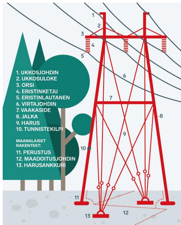
Kuva 6-4. Voimajohdon osat (Fingrid, 2022).
