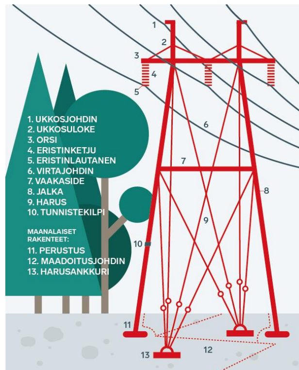
Kuva 6-4. Voimajohdon osat (Fingrid, 2022).
